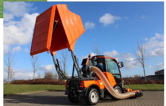
Dieser Mäh-Saug-Container ist bauartbedingt vorgesehen, zum Absaugen von Grasflächen in Verbindung mit einem Frontsichelmähwerk, wobei beim Absaugen die Grasmenge sich auf die Leistung des Mähwerkes beschränkt. Es dürfen keine anderen Materialien wie Gras und Laub abgesaugt werden.
