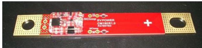
Die Leiterplatte ist direkt am + und ÷ Pol der Zelle montiert und hat zwei Funktionen:
