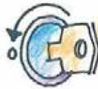
Drehen Sie den Zündschlüssel auf "0" und unterbrechen Sie die Stromversorgung.
