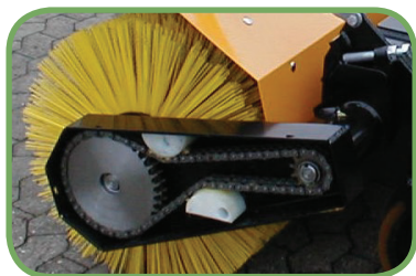
Automatischer Kettenspannung ind Duplex-Ketten
