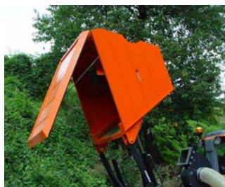
Hydraulische Hochentleerung 2 m
