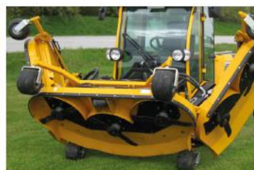
Hydraulischer Tilt Up (Steilaushebung)
