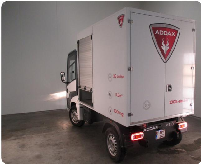
Geschlossene Aluminium Box inkl. zwei Hecktüren und einer seitlichen 80 cm Rolladentür
