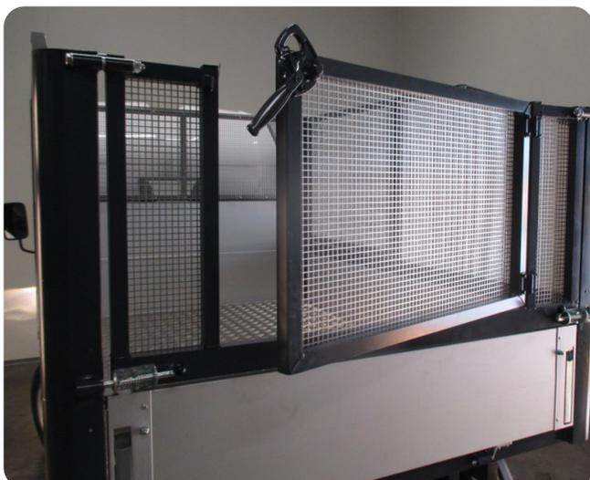
Gitteraufbau optional mit Hecktüre
