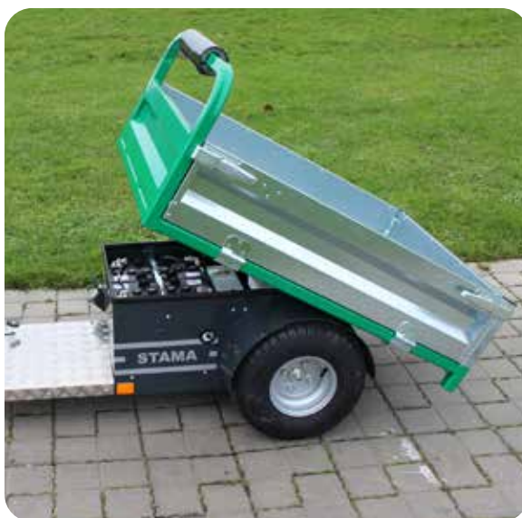
Kipper zum Entladen und Zugang zur Batterie
