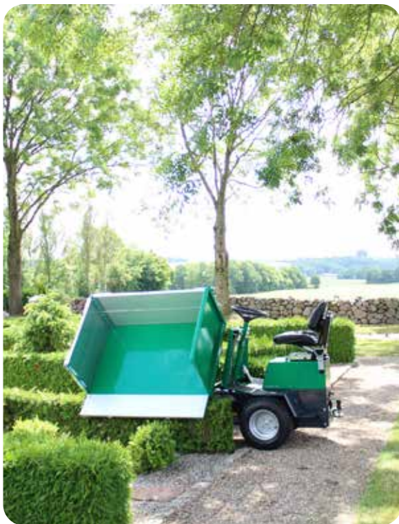
3-Seiten Kipper zum einfachen entladen
