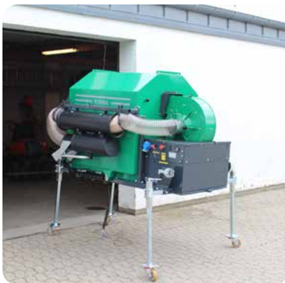
Abnehmbare, fahrbare Abstellstützen zum sicheren Abstellen
