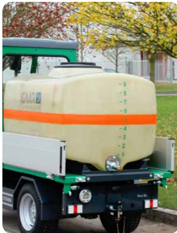
Optionale 1000 L Gießanlage und elektrische Unterflurpumpe
