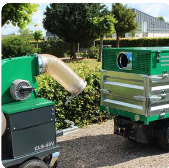
Schnelles Abkoppeln der Saugereinheit zum Fahrzeug
