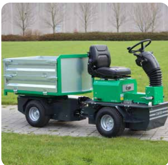
Wendbare Fahrerplattform für Ladepritsche vorne oder hinten
