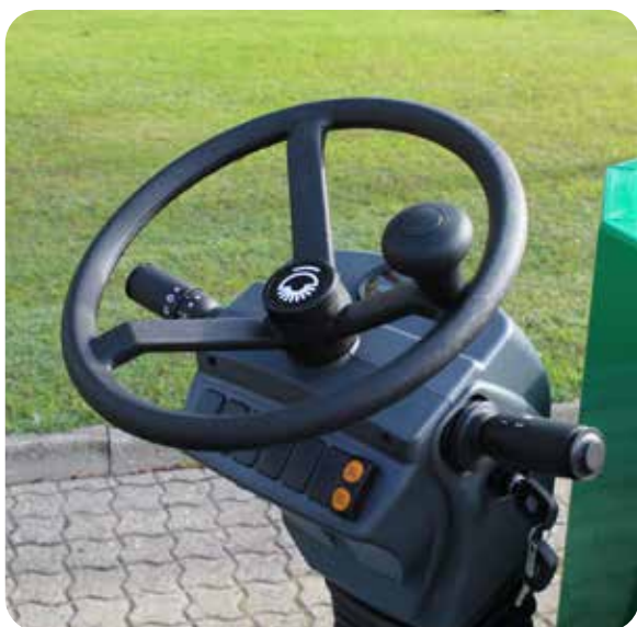
Stufenlos verstellbare Lenksäule
