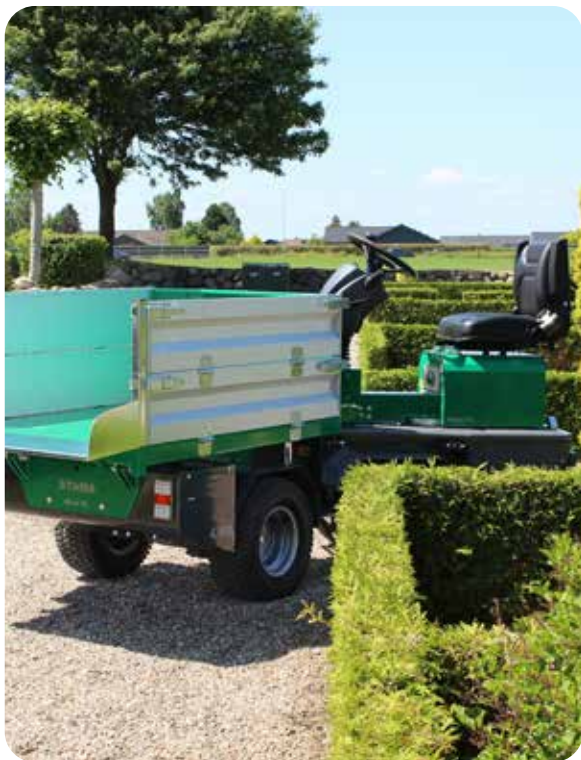
Knicklenkung für maximale Wendigkeit auf schmalen Wegen.
